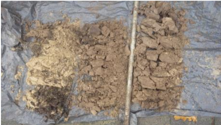
Boring 3: Overzicht boorkernen (uitgelegd van linksonder naar rechtsboven).
