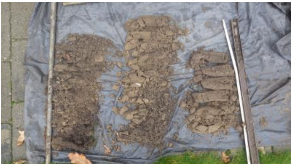
Boring 4: Overzicht boorkernen (uitgelegd van linksonder naar rechtsboven).
