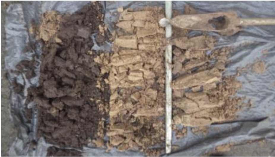
Boring 1: Overzicht boorkernen (uitgelegd van linksonder naar rechtsboven).
