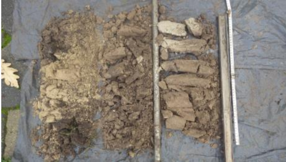
Boring 5: Overzicht boorkernen (uitgelegd van linksonder naar rechtsboven).
