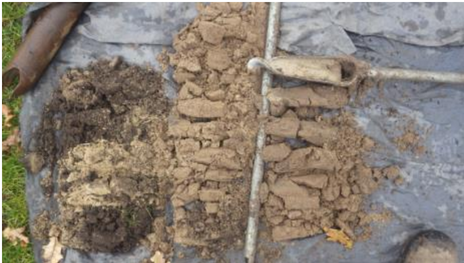
Boring 2: Overzicht boorkernen (uitgelegd van linksonder naar rechtsboven).
