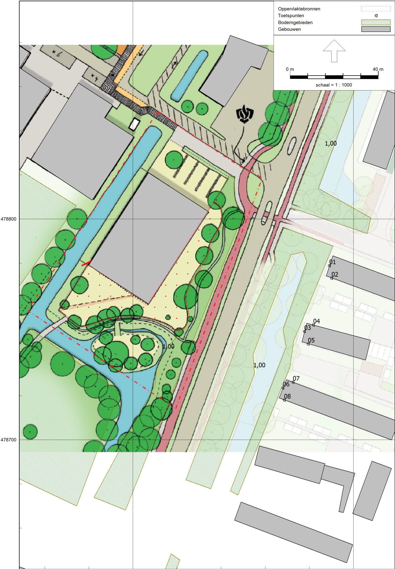
Figuur 1. Weergave rekenmodel langtijdgemiddelde geluidniveau
