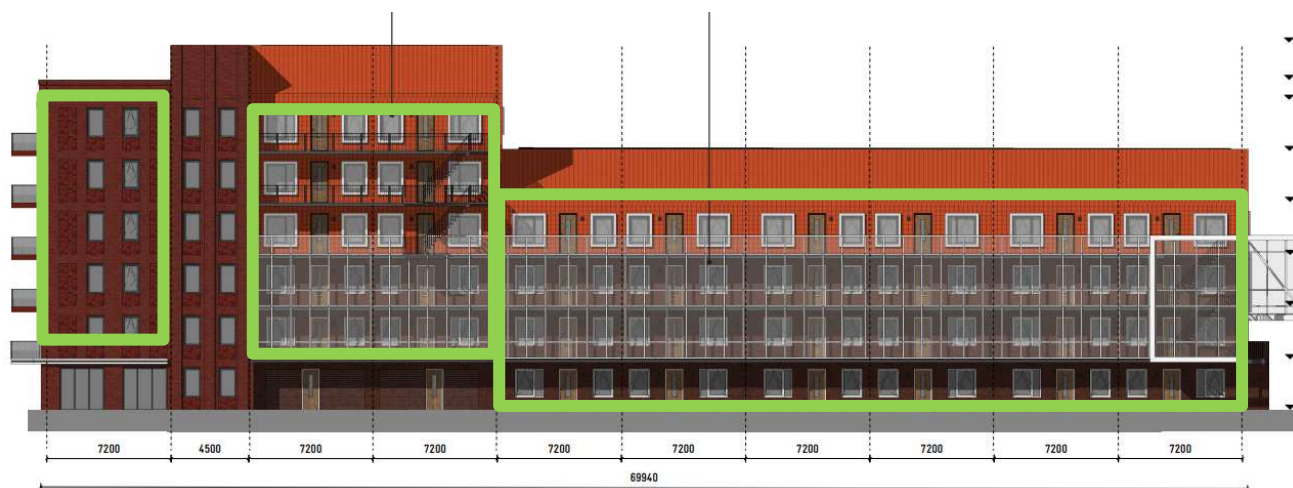
figuur 3 situering vliesgevel noordgevel blok 8, groene kaders
