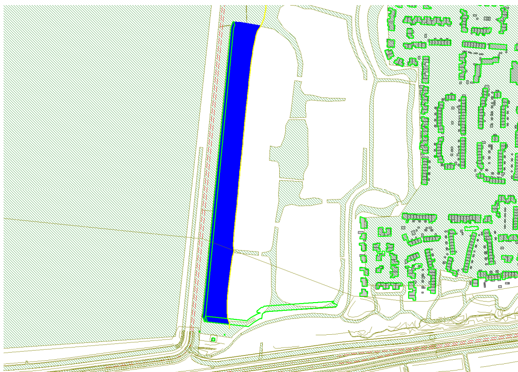
Figuur 4.1 Overzicht van het gebied met een overschrijding van de ten hoogste toelaatbare geluidbelasting [ L_{den} 48 dB] ten gevolge van verkeer op de Raadhuislaan
