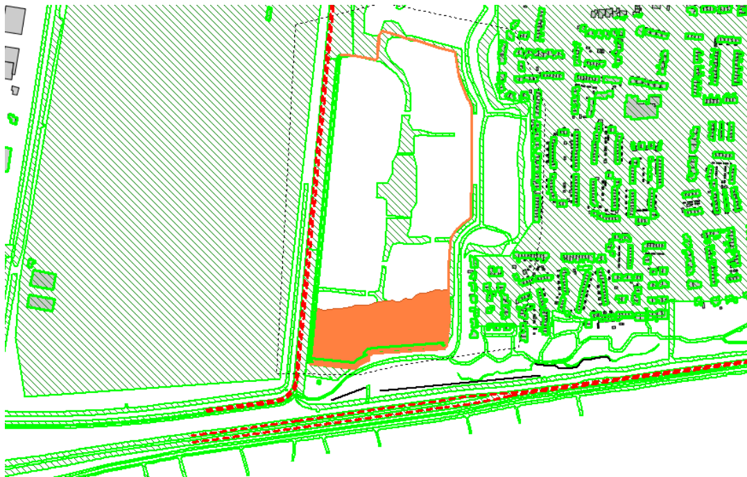
Figuur 4.2 Overzicht van het gebied met een overschrijding van de ten hoogste toelaatbare geluidbelasting [ L_{den} 48 dB] ten gevolge van verkeer op de N506
