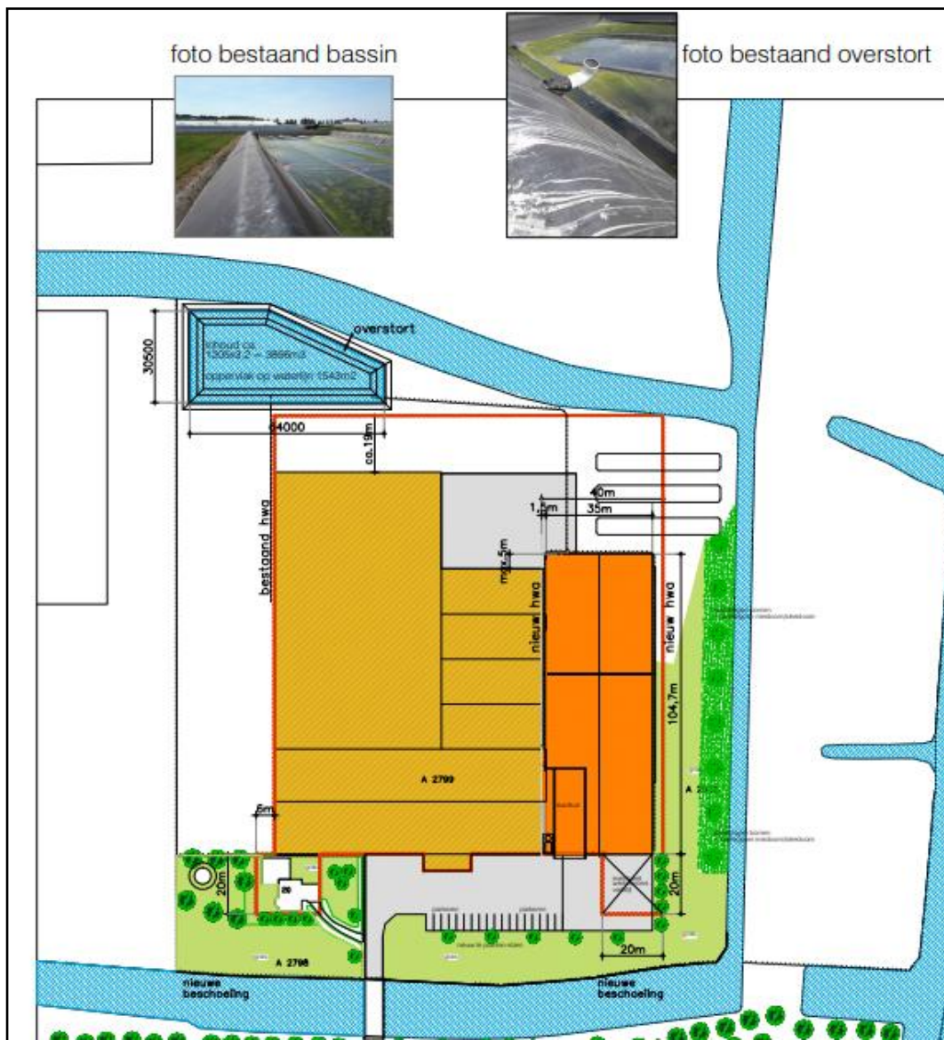
afb. 11 De uitbreiding (rode lijn) in relatie met het bestaande waterbassin
