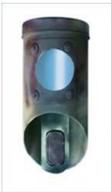
Struikrover. In de buis zit een camera en voor de camera ligt een lokmiddel.
