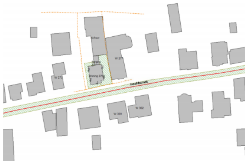
Figuur 2: Plot van het geluidoverdrachtsmodel met vier beoordelingspunten op de gevels van de woning.
