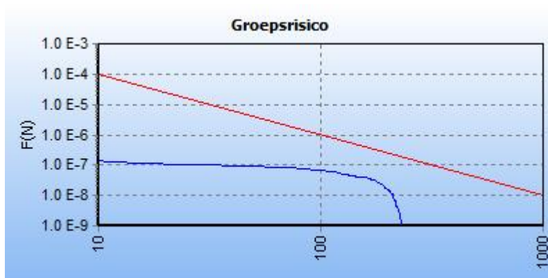
Afbeelding 5 fN-curve buisleiding W-573-05-deel-1, huidige situatie
