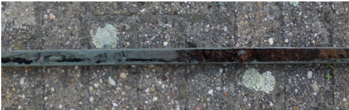
Figuur 10: Foto van het pakket bruingrijze klei met veenbrokjes (midden) dat in alle boringen tussen de door kleilaagjes onderbroken zandpakket (links) en het veen (rechts), is aangetroffen. In het door kleilaagjes onderbroken zandpakket zijn oxidatievlekken zichtbaar
