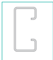
Figuur 26 doorsnede paaltje onderconstructie
