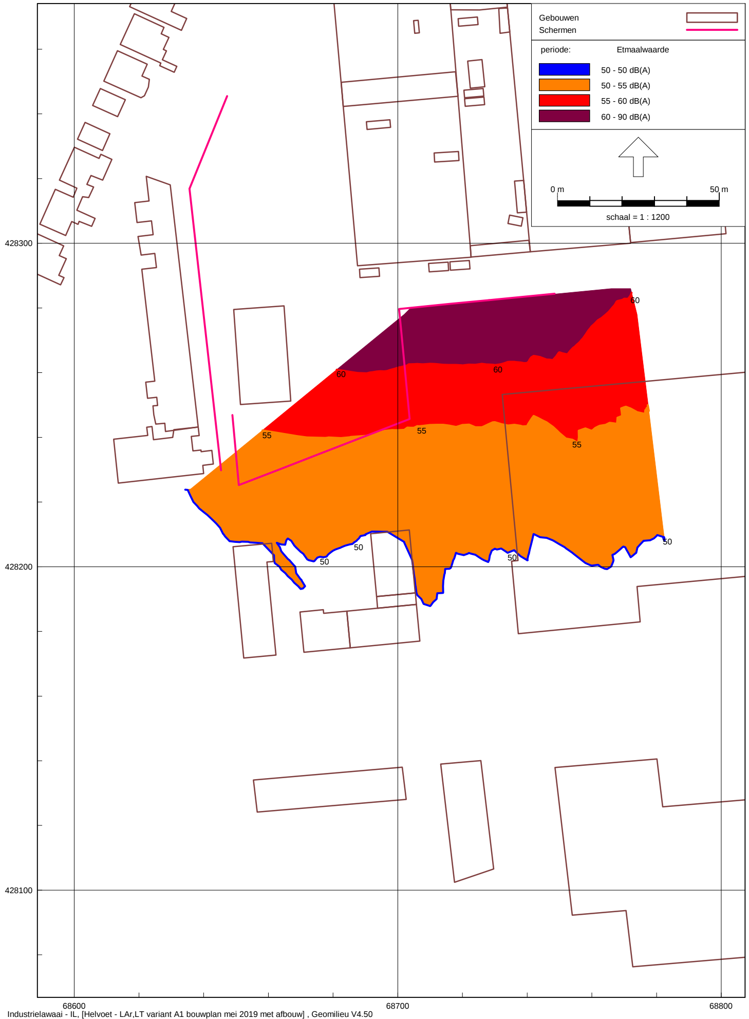
Figuur cB03 Variant B Contouren hoogte 9 meter
