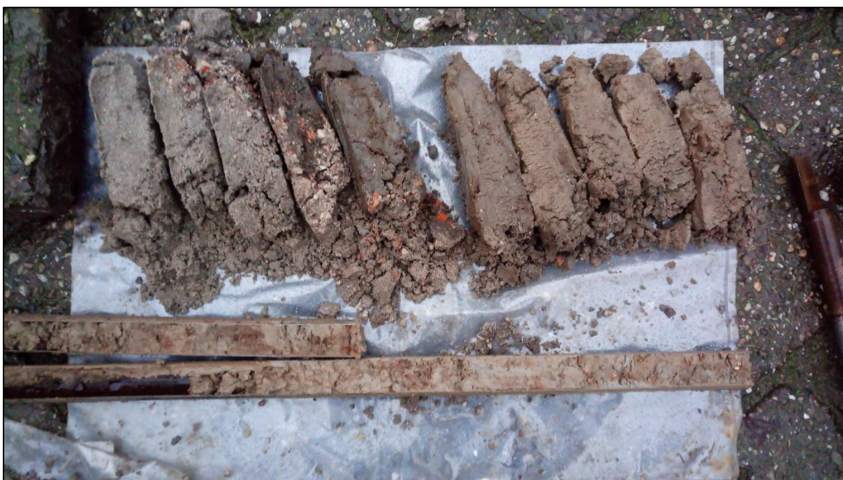
Boring 19: 0-200 cm -Mv. vanaf circa 30 cm -Mv is het humeuze kleipakket met bouw materiaal aanwezig.
