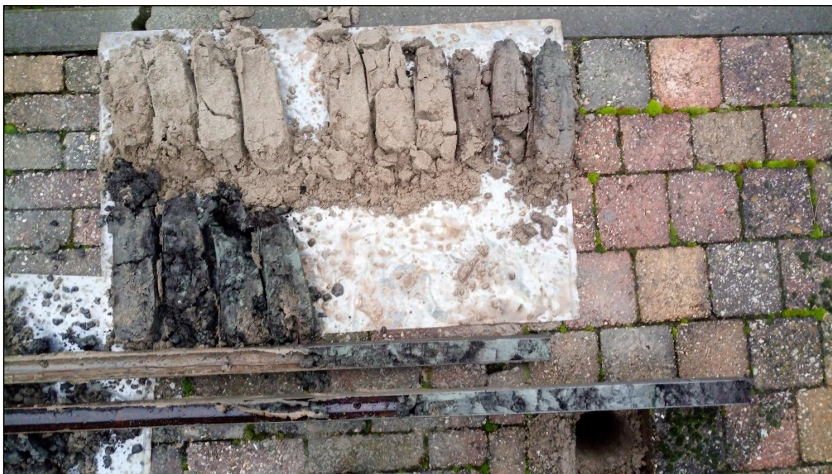
Boring 20167: 0-250 cm -Mv. In de top (vanaf ongeveer 80 cm -Mv) is een humeus kleipakket aanwezig. Daaronder bevindt zich een rommelig kleipakket met veenbokken.
