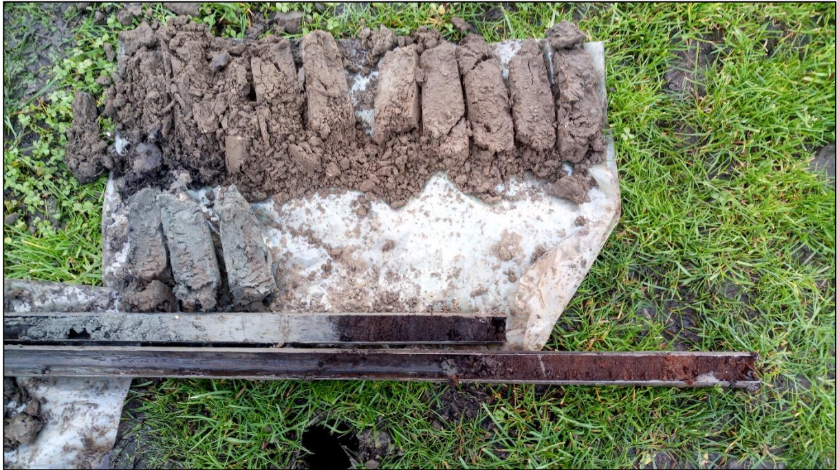
Boring 6: 0-200 cm -Mv. De veraarde top bevindt zich aan de rechterzijde in de bovenste guts.
