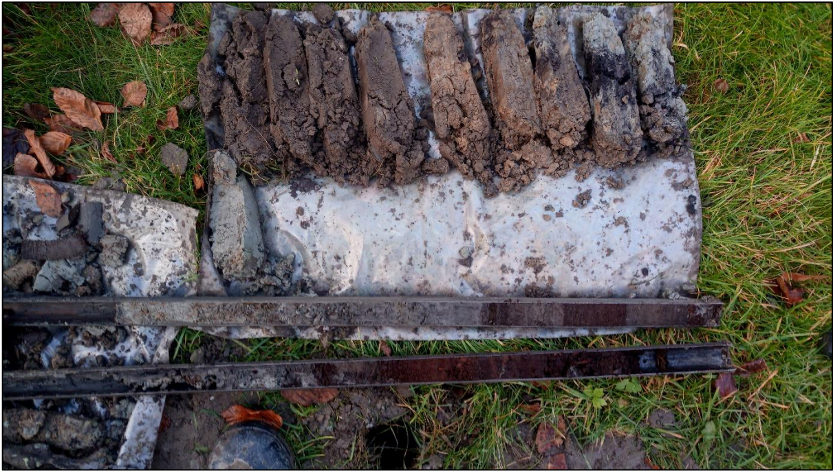
Boring 15: 0-300 cm -Mv. Op deze foto is de geërodeerde top van het Hollandveen te zien (in de bovenste guts aan de rechterzijde).
