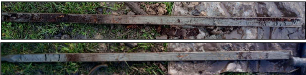
Boring 7: Traject 300 – 500 cm -Mv (onderkant Hollandveen en Afzettingen van Calais.
