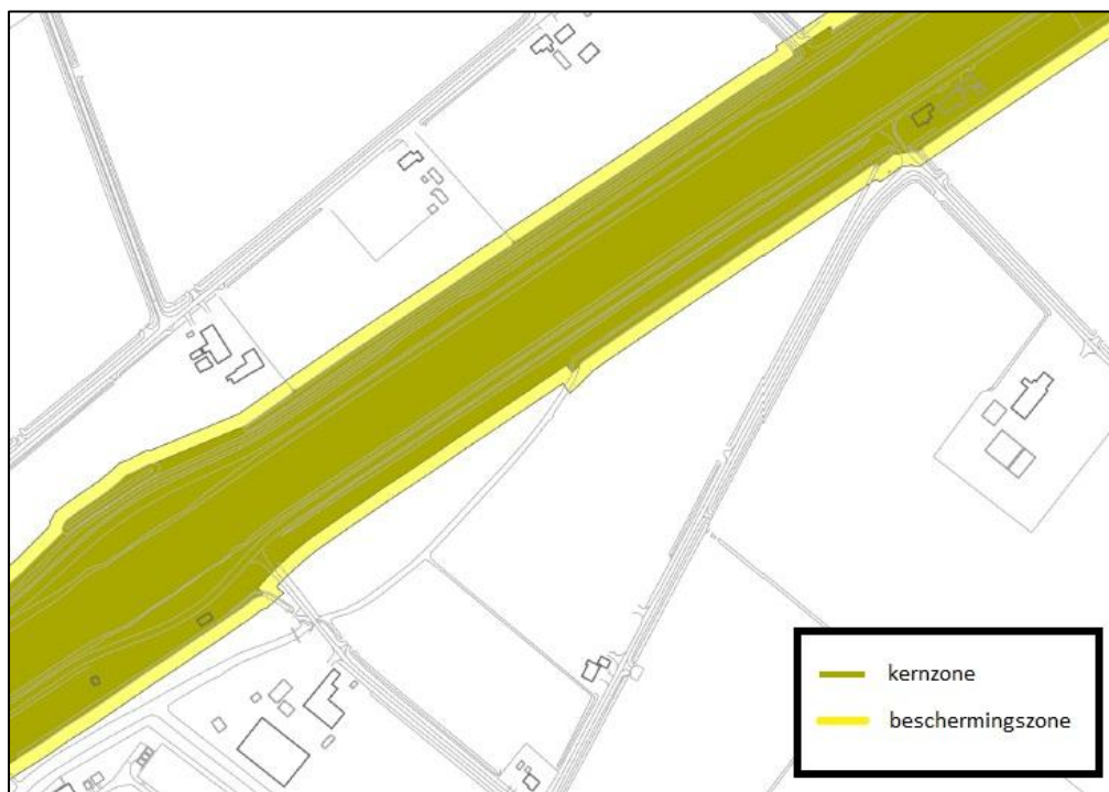
Figuur 4.1: zonerings waterkering (bron: waterschap Hollandse Delta)
