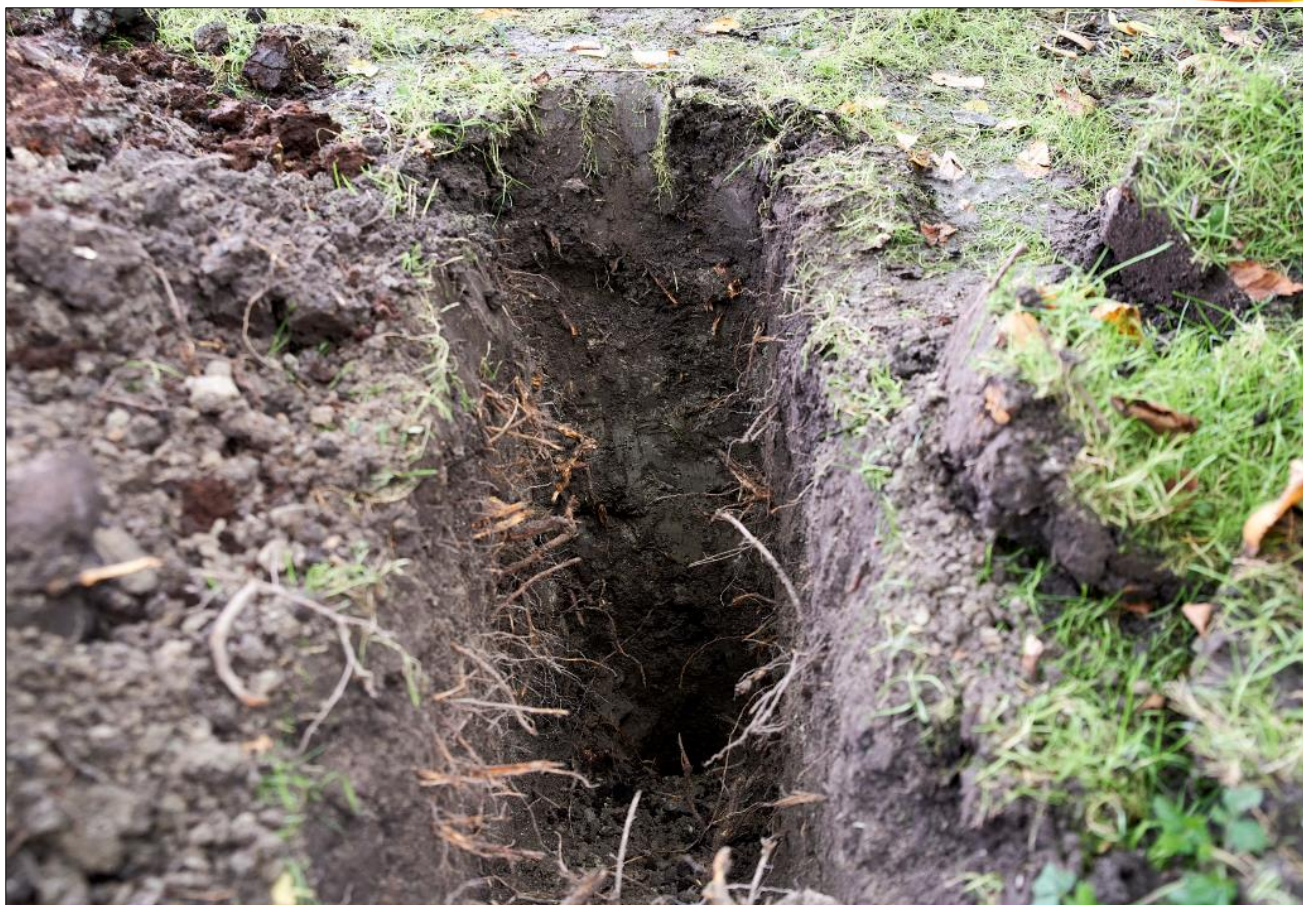
Foto 5: Intensieve beworteling in de kleiige bovenlaag van proefsleuf 3 aan de Hengelolaan.
