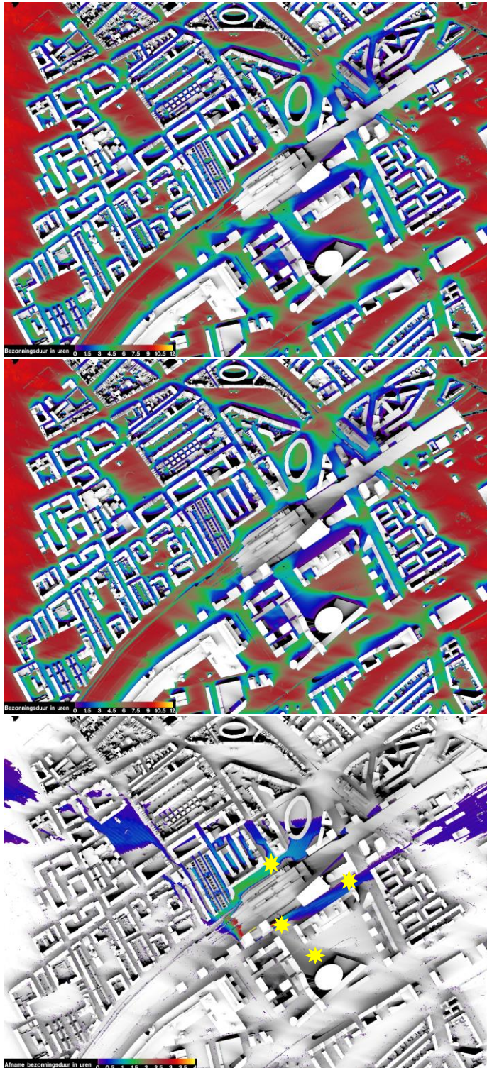
f 3.4 Mogelijke bezonningsduur van de openbare ruimte voor de datum 21 oktober in de huidige bebouwingssituatie (boven), de geplande bebouwingssituatie (midden) en het verschil tussen deze situaties (onder).
