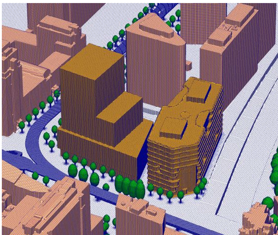
f3.7 Aanzicht oppervlakte grid rekenmodel alternatieve situatie, toren RVB 75 meter, inclusief geplande begroeiing
