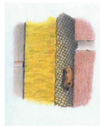
Ingemetselde geschakelde inbouwkasten voor vleermuizen en vleermuisvriendelijk isolatiemateriaal (met grip). Brochure 'Vleermuisvriendelijk bouwen', Zoogdiervereniging.
