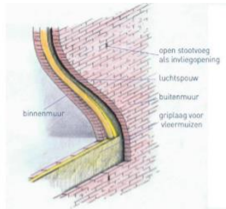
Ingemetselde geschakelde inbouwkasten voor vleermuizen en vleermuisvriendelijk isolatiemateriaal (met grip). Brochure 'Vleermuisvriendelijk bouwen', Zoogdiervereniging.
