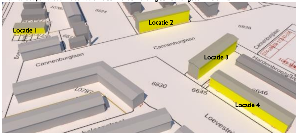
Afb. 3: Positie rekengrids ten behoeve van de berekening bezonningsduur
