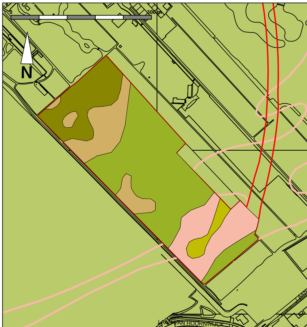
Afb. 3 Nieuwe geologie van het gebied Broekpolder op basis van het in 2010 uitgevoerde booronderzoek.
