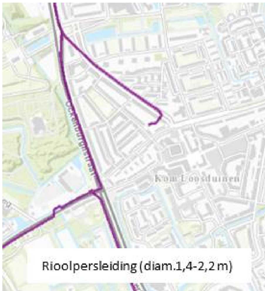
Afbeelding 2: rioolpersleidingen nabij het plangebied (bron: gemeente Den Haag)
