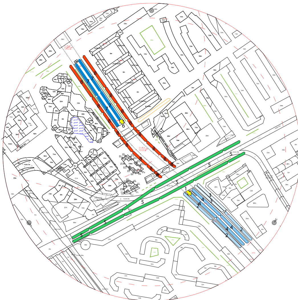
f3.2 Schematisch overzicht van de lijnbronnen in het zuidelijke schaalmodel.
