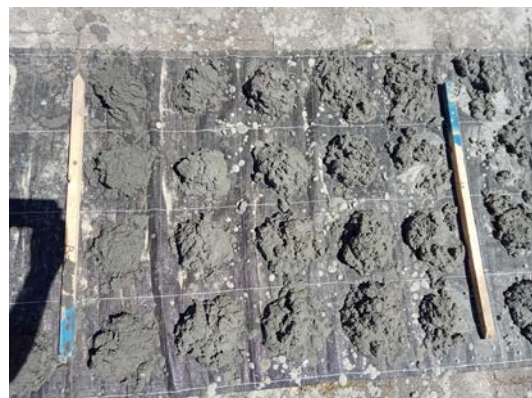
24. B-03 Boorlaag 10 – 15m – mv
