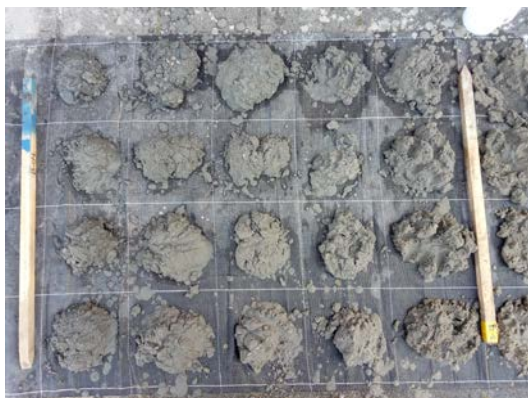
23. B-03 Boorlaag 5 – 10m – mv
