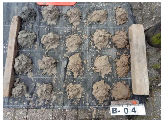
16. B-04 Boorlaag 0 – 5m – mv
