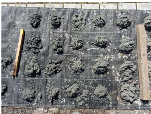
17. B-04 Boorlaag 5 – 10m – mv
