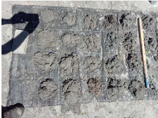
25. B-03 Boorlaag 15 – 20m – mv
