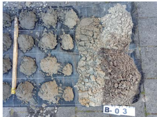
22. B-03 Boorlaag 0 – 5m – mv
