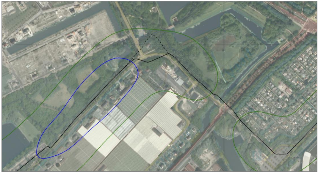
Figuur 2. PR-contouren aardgasleiding W-509-02 bestaande situatie
