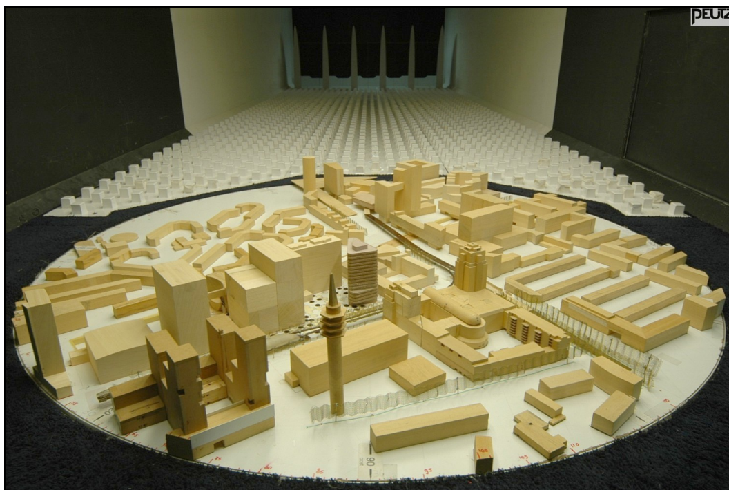
Figuur 1: Maquette in de windtunnel.
