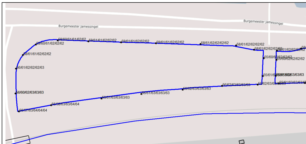
Figuur 19: L_{den} t.g.v. traject Gouda – Rotterdam t.p.v. bestemmingsvlak A1 west na toepassen raildempers
