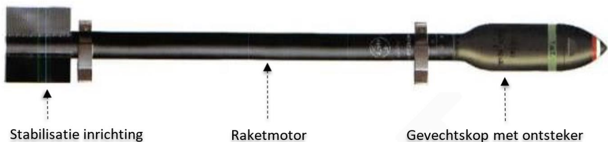
Figuur 11: Algemene opbouw raket
