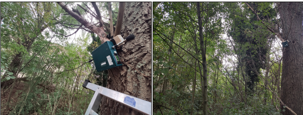
Figuur 6. Ophanging met de Songmeter met 2 microfoons in het boomvak aan de Burg. Mijssingel.
