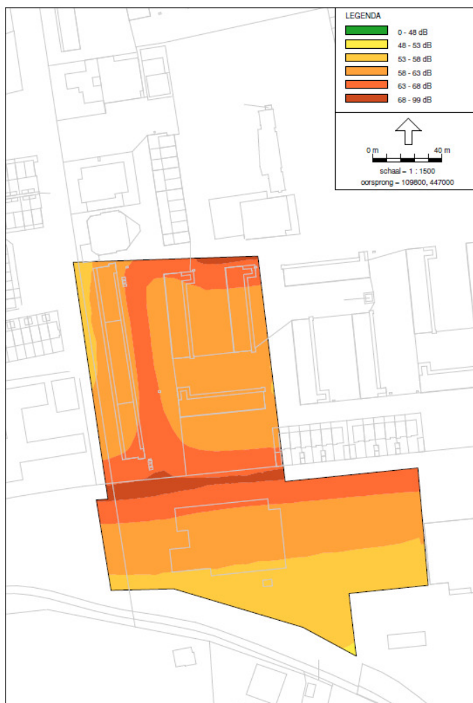
Figuur 2: Geluidscontouren ten gevolge van alle relevante wegen excl. aftrek art. 110g Wgh
