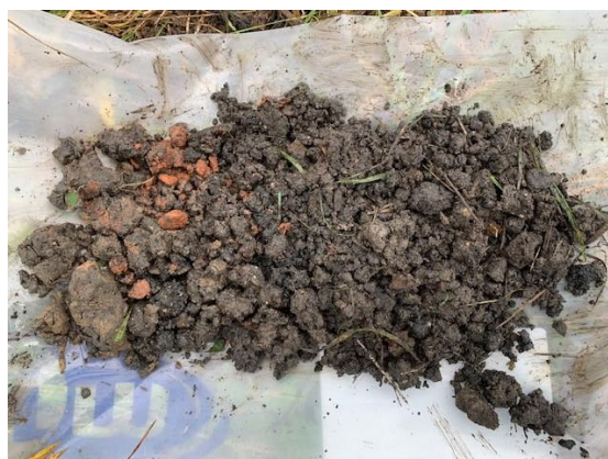
Detailfoto opgeboord stortmateriaal
