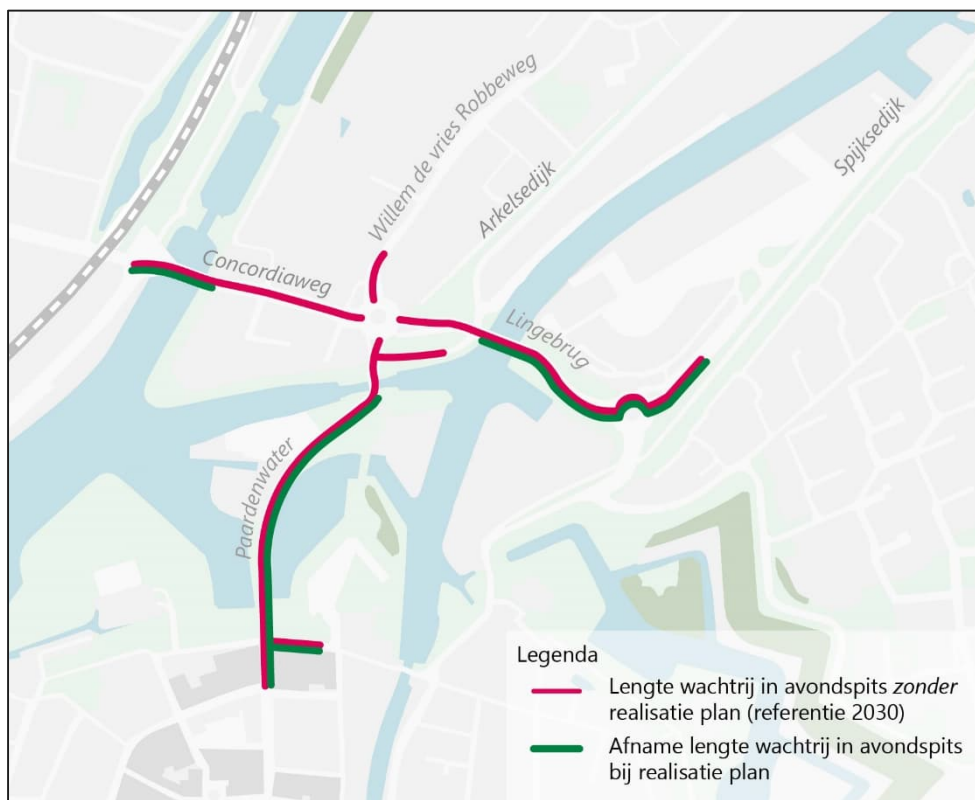
Figuur 4.4: Gemiddelde maximale wachtrijlengte (exclusief opening van brug en spoorweg-overgang) in de referentiesituatie en afname door het Plan
