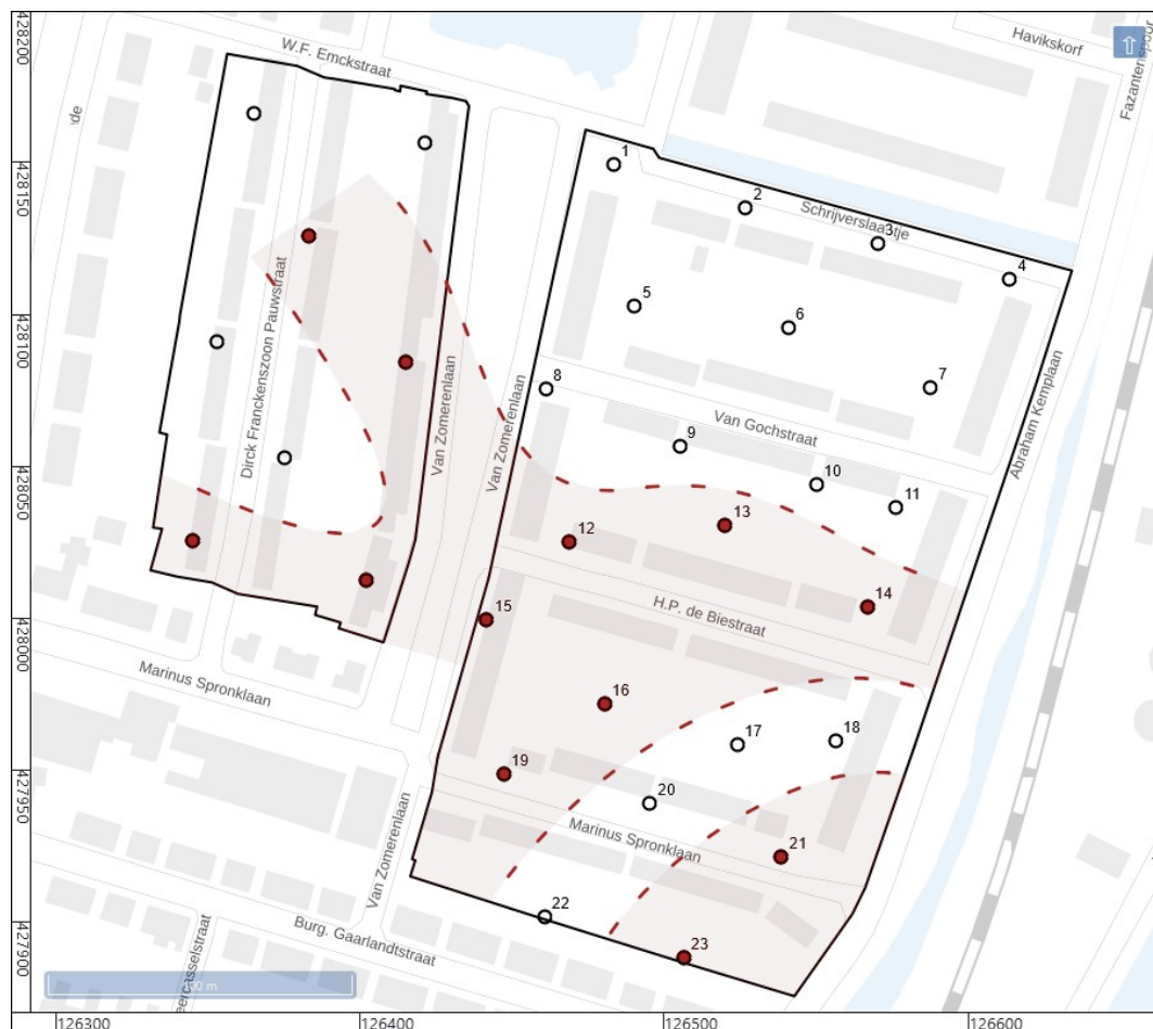
Figuur 36: Boorpuntenkaart van het huidige onderzoek en het naastgelegen onderzoek uit 2020 (Roodenburg 2020). Aangegeven zijn de boorpunten waarin oeverafzettingen binnen 500 cm -mv zijn aangetroffen en een zone gebaseerd op deze punten.
