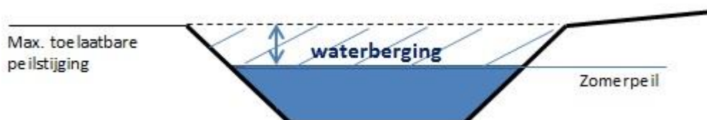
Figuur 4: voorbeeld waterberging in oppervlaktewater
