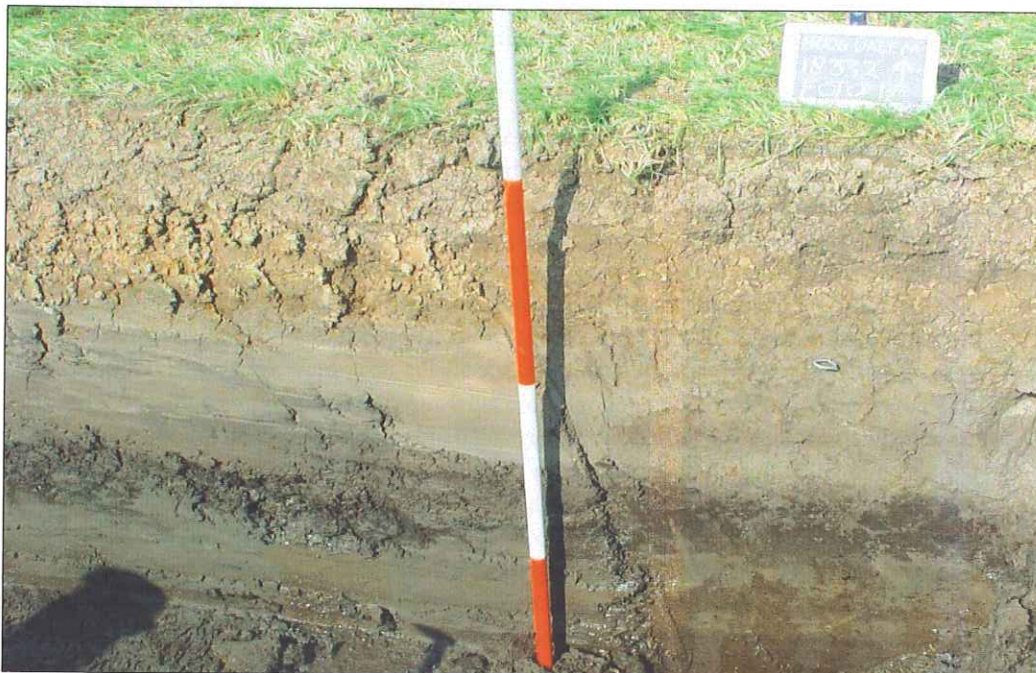
Afb. 4: Profielkolom met aan de rechterzijde van de jalon een geschoond profiel waarin het bosveen zichtbaar is dat afgedekt wordt door een pakket van 60 cm klei.
