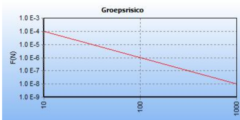
5.4 Figuur 5.4 FN curve voor 5365_leiding-W-528-15-deel-1 van N.V. Nederlandse Gasunie voor de kilometer tussen stationing 0.00 en stationing 500.00
