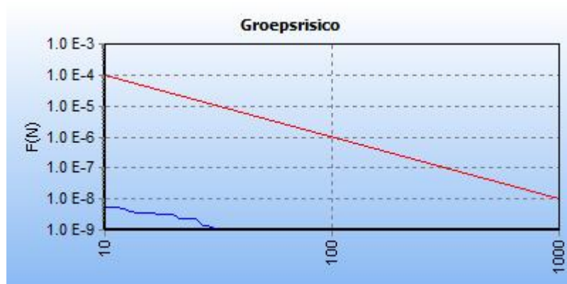
Figuur 2.7: fN-curve buisleiding W-528-01-deel-1 ná planrealisatie
