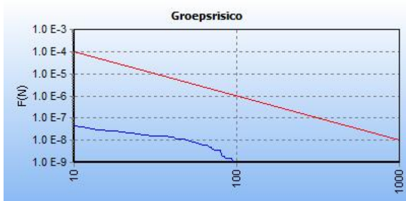
5.6 Figuur 5.6 FN curve voor 5365_leiding-W-543-02-deel-1 van N.V. Nederlandse Gasunie voor de kilometer tussen stationing 0.00 en stationing 1000.00
