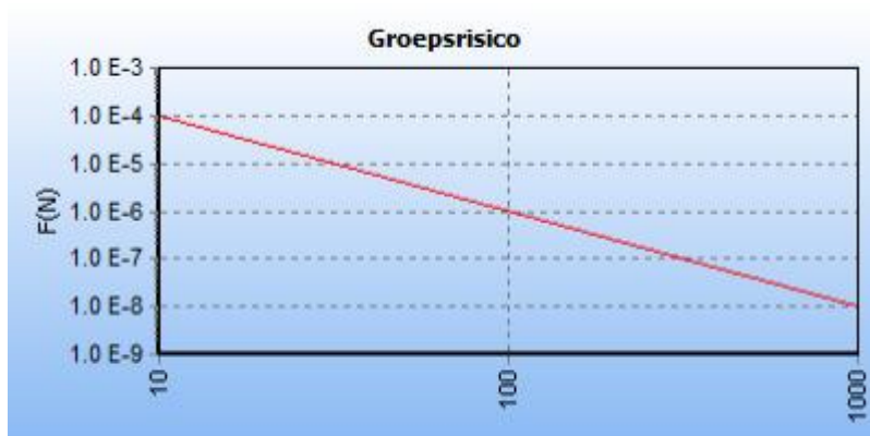
5.5 Figuur 5.5 FN curve voor 5365_leiding-W-543-01-deel-1 van N.V. Nederlandse Gasunie voor de kilometer tussen stationing 0.00 en stationing 1000.00
