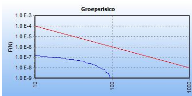
5.5 Figuur 5.5 FN curve voor 5365_leiding-W-543-01-deel-1 van N.V. Nederlandse Gasunie voor de kilometer tussen stationing 0.00 en stationing 1000.00
