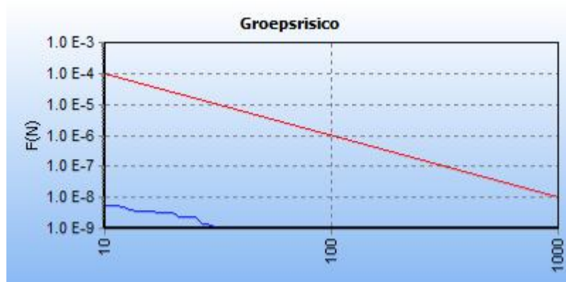
Figuur 2.6: fN-curve buisleiding W-528-01-deel-1 vóór planrealisatie
