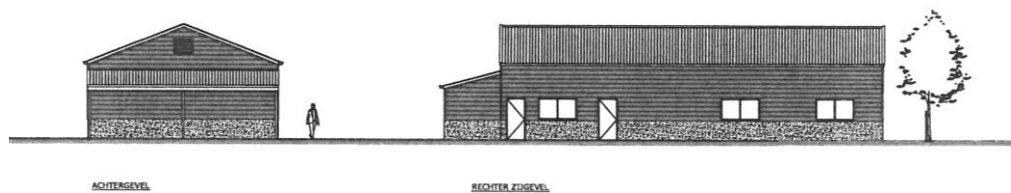
Aanzichten nieuw te bouwen loods (links: achtergevel, rechts: rechterzijgevel)
