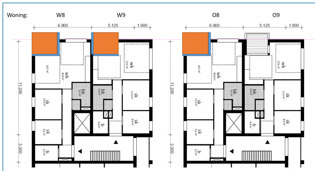
Figuur 4.9 Plattegrond appartementen met een geluidluwe gevel (blauw) gecreëerd door de serre of loggia (oranje).
