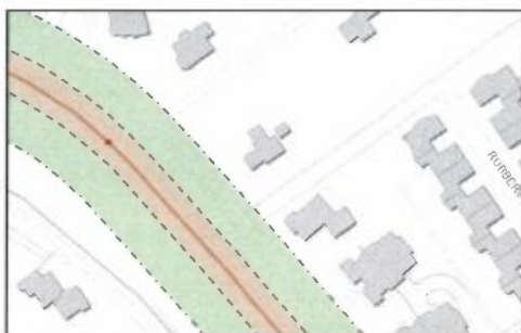
Afbeelding: uitsnede van de leggerkaart van het waterschap ter plaatse van de projectlocatie langs de Oostsingel. Zichtbaar is dat de beschermingszone de westelijke zijde van het projectgebied overlapt.
