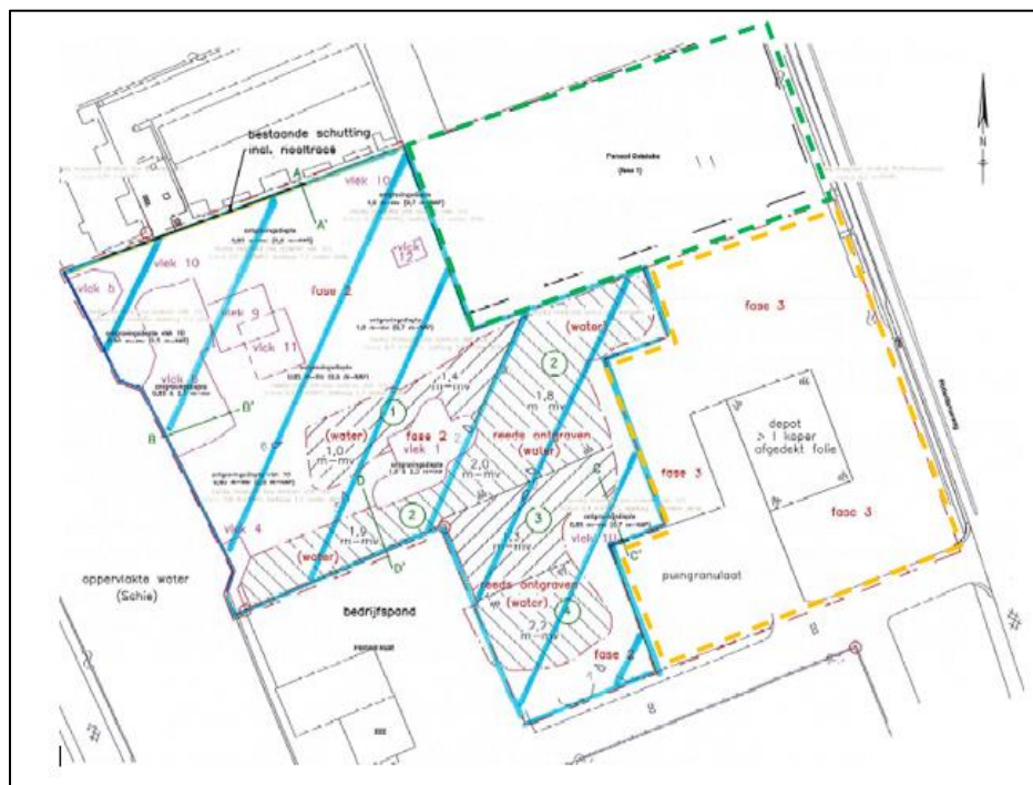
Figuur 2: Weergave fasering bodemsanering
