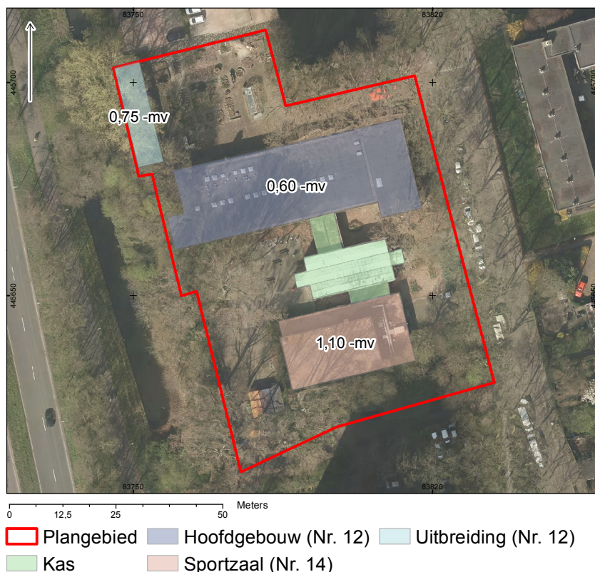
Afbeelding 2: diepte van de te slopen funderingen geprojecteerd op een luchtfoto (bron: gemeente Delft).
