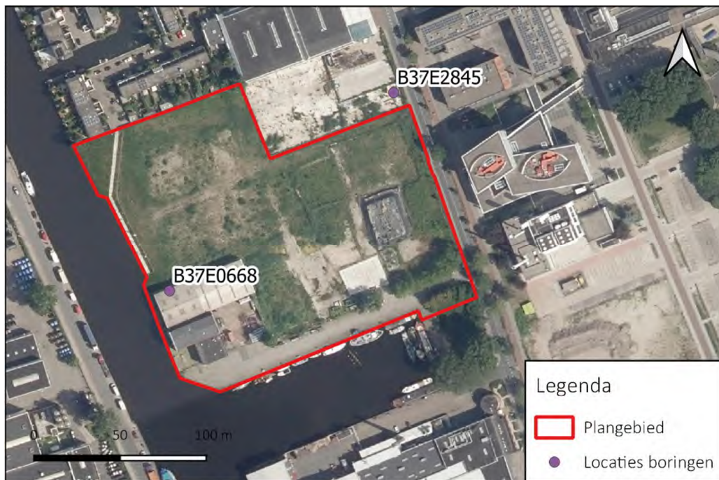
Figuur 4 Locaties van grondboringen in en om het plangebied.
