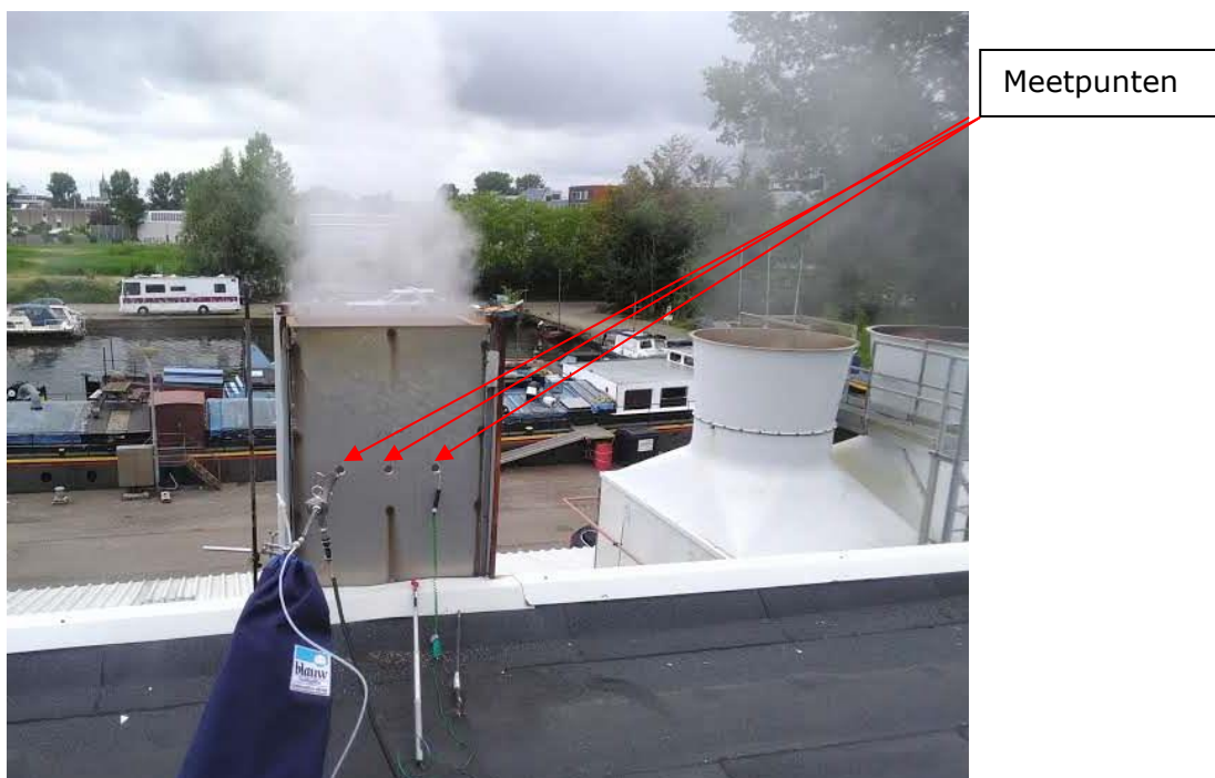
Figuur 2.5 Meetsituatie bij de condensaatbeluchting
