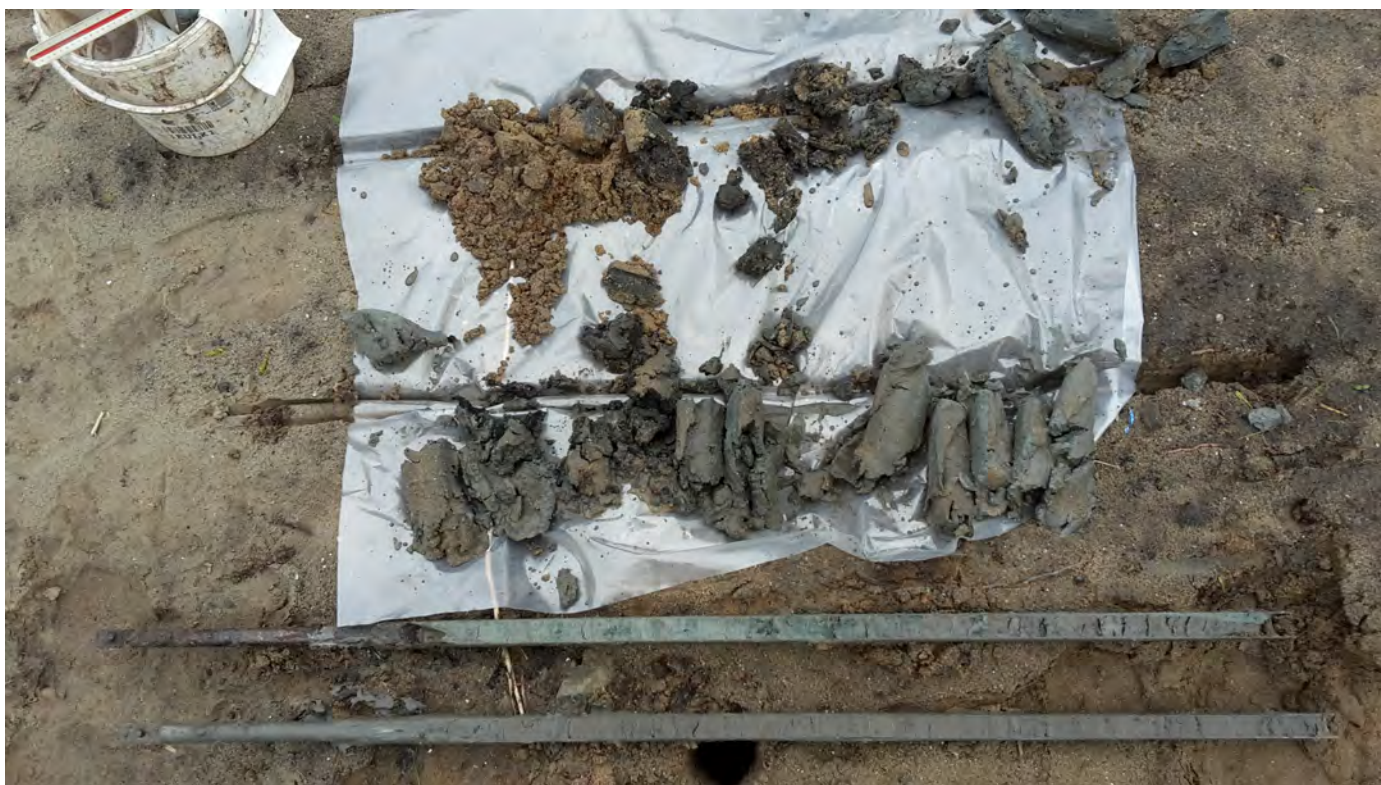
Afb. 21: boring 001. In de gutsen is duidelijk de laminatie te zien. De leesrichting is van linksboven naar rechtsonder.
