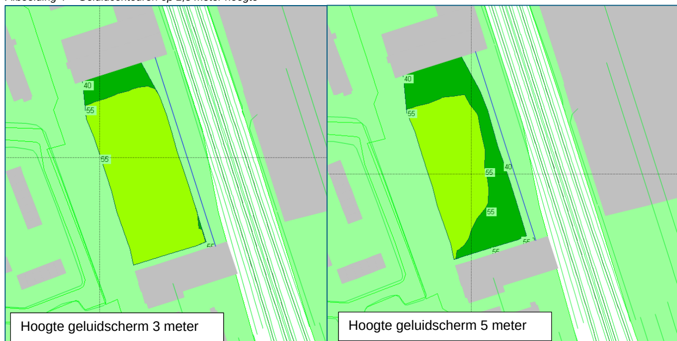
Afbeelding 4 - Geluidcontouren op 1,5 meter hoogte
