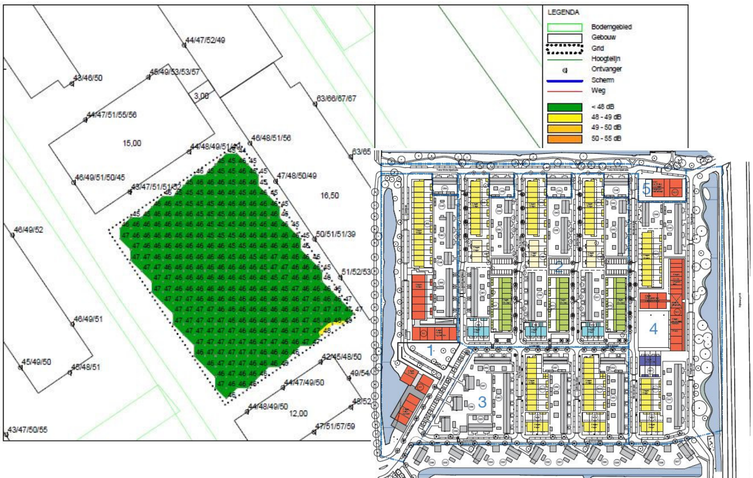
Abbeelding 1: Bomenwijk Delft. Het gebouw nabij plein 4 (inzet) zorgt door de hoogte en ligging parallel aan de geluidsbron voor afscherming van het achtergelegen gebied en de aanwezigheid van een geluidluw plein direct achter het gebouw.
