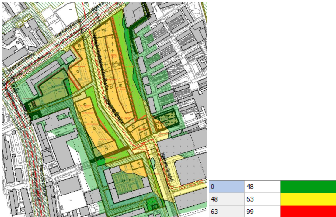
Figuur 4.3: Geluidcontourenplot Nieuwe Gracht (nieuwe interne ontsluitingsweg) inclusief aftrek artikel 110g Wgh
