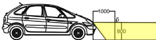
Figuur 6.1: Koplamphoogte (800 mm) en dalingshoek (5 mm/meter)
