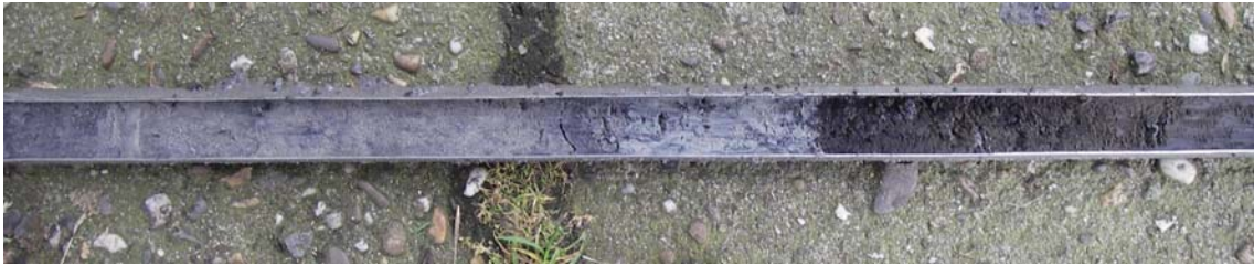
Figuur 11: De venige klei die in boring 40 is aangetroffen. Hierboven (links op de foto) is de ongelaagde rommelige klei te zien zoals deze ook in de boringen 8, 9, 10, 15, 30 en 39 is aangetroffen.
