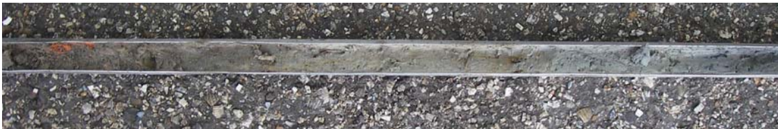
Figuur 12: Boring 15 met bovenin (links) de sterk humeuze klei die overgaat in matig humeuze klei. Duidelijk zijn de deeltjes baksteenpuin te zien.
