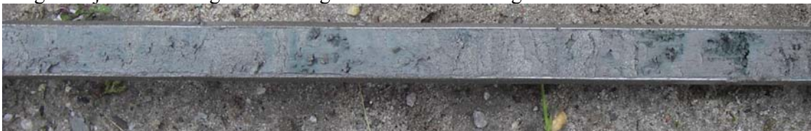
Figuur 13: De klei met zandlaagjes die vrijwel overal vanaf 1,0 tot 1,25 m –NAP is aangetroffen.
