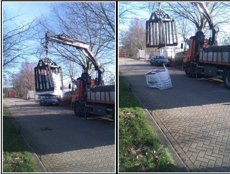
Figuur 2: Bepaling trillingoverdracht vloer met vallende bigbag zand
