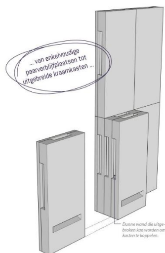
Faunaprojecten VMPM3 en VMPM3u schakelbare inbouwkasten (48,7 x 22 x 14,5 cm)
