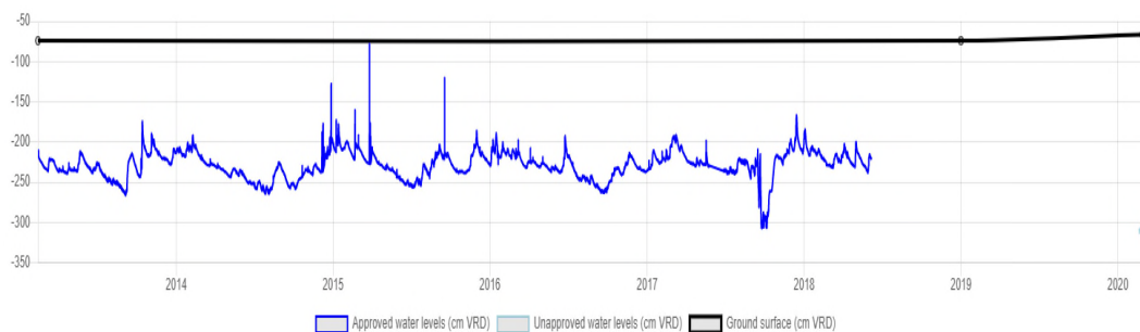
Figuur 2-11: Meetnet B, grondwatermetingen in het plangebied over verschillende tijdsperiodes, de hoogteligging van het plangebied (t.o.v. maaiveld) is aangegeven met een zwarte lijn.
